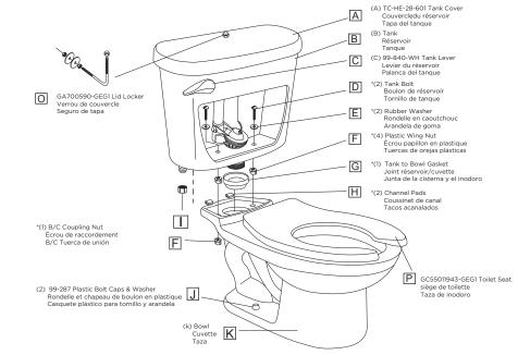
NOTE: Parts with \* are included in unit bag, 99-828 REMAQUE: Les piéces portant un \* sont incluses dans ie sac. AVISO: Las partes con \* están incluidas en la bolsa de la unidad
